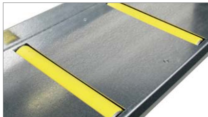
型材支撑辊道 01
