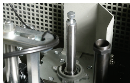
Pneumatisk system til hurtig udskiftning
