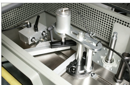
Clamps og aggregat til ikke-retvinklet fræsning
