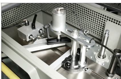
Clamps og aggregat til ikke-retvinklet fræsning
