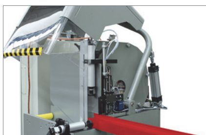
Profiilin vahvuuden elektroninen mittauslaite (valinnainen) 04
