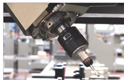
Dispositif de mesure électronique du profilé (en option)
