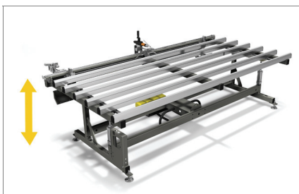
Pneumatyczny układ wychylenia blatu roboczego
