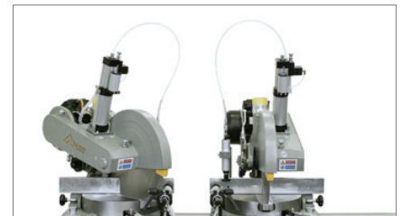
Rotação das cabeças móveis
