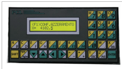
Visor digital do eixo x
