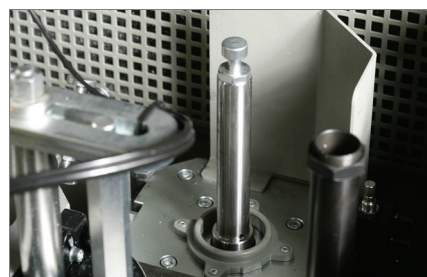
Быстрая пневматическая замена фрез 05
