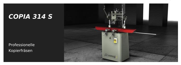
Manuelle Einspindel-Kopierfräse mit langem vertikalem Verfahrweg und Verfahren vom Fräskopf durch Griff oder Umlenkhebel. Durchführung von durchgehenden Bearbeitungen ohne das Werkstück zu drehen. Manueller Kopierstift.
