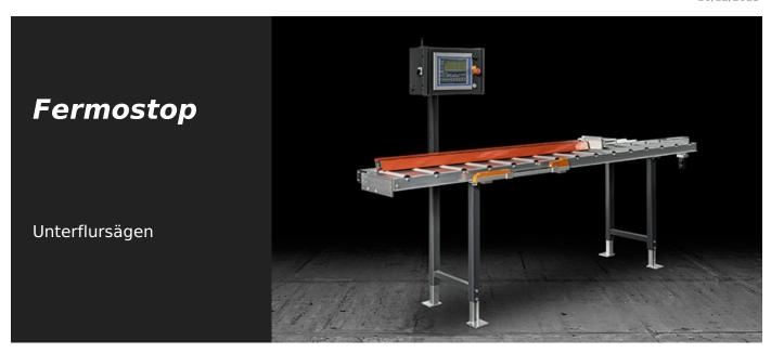
Profilauflage und Längenanschlag mit Verfahrbewegung des Abschlags auf CN-Achse und elektronische Erfassung über einen Absolut-Magnetstreifen. Mit einem elektronischen Messsystem ausgestattet, das es ermöglicht, die Daten im internen Speicher zu speichern oder über Bluetooth in Echtzeit an einen PC oder die Steuerung einer Kappsäge zu übertragen. Ermöglicht hoch präzise Bearbeitungen und die Wiederholbarkeit der Positionierung.
