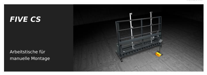
Kontrollpresse für Fenster und Türen aus Aluminium. Ermöglicht die Simulation der Bedingungen, unter denen die Elemente benutzt werden. Der Rahmen wird auf der gesamten Höhe durch ein System verstellbarer Spanner gespannt. Die Flügel werden in den Rahmen eingehängt, dann erfolgen Verglasen und Endkontrolle. Ein Untergestell mit Rollenbahn erleichtert das Be- und Entladen schwerer Fensterelemente.
