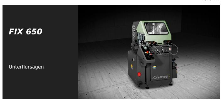
Einkopfsäge mit von unten kommendem Sägeblatt für das Schneiden von Stücken mit großem Querschnitt. Nur für 90°-Schnitte geeignet.
