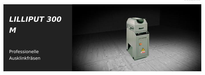
Horizontale Ausklinkfräse mit manuellem Vorschub. Nicht rechtwinklige Fräsebearbeitung +45° / 90° / -45°. Pneumatische Schnellwechselvorrichtung de Fräseinheit. Kratzfester Arbeitstisch und Arbeitsbereich mit Vollraumschutz.
