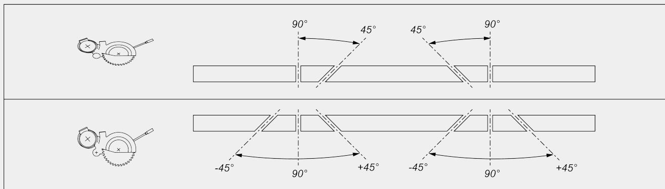
Mechanische Einstellung der Zwischenwinkel
