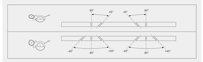
Mechanische Einstellung der Zwischenwinkel
