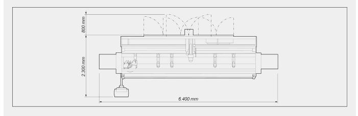
Die Gesamtabmessungen können der Produktkonfiguration entsprechend variieren.
