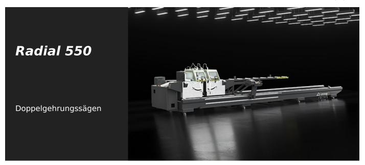
Elektronische Doppelgehrungssäge mit radialer Bewegung der Sägeblätter, automatischer Bewegung des verfahrbaren Sägeaggregats auf Kugelumlaufschuhen über ein Ritzel- und Zahnschienensystem, interner Kippfunktion bis auf 30°, geeignet für das Schneiden von Profilen mit großen Abmessungen. Der Sägeblattvorschub wird über ein Paar ölpneumatischer Zylinder gesteuert.
