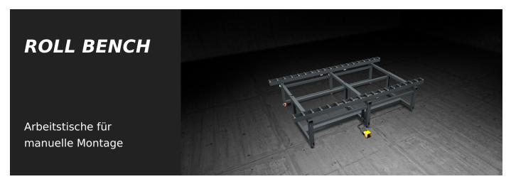
Großer Montagetisch mit modularem Aufbau für Montage und Inline-Handling von Fassadenelementen. Der Montagetisch ist mit zwei Rollenbahnen mit Überzug aus weichem PVC ausgestattet, deren Abstand je nach Breite des Werkstücks verstellt werden kann. Mithilfe eines pneumatischen Klemmsystems werden die Rollen während der Bearbeitungsphasen geklemmt.
