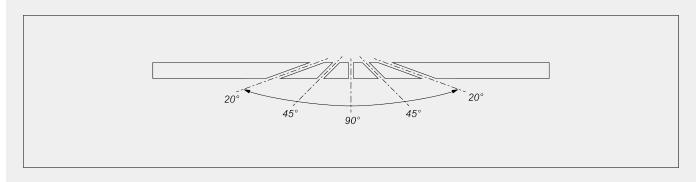
Mechanische Einstellung der Zwischenwinkel
