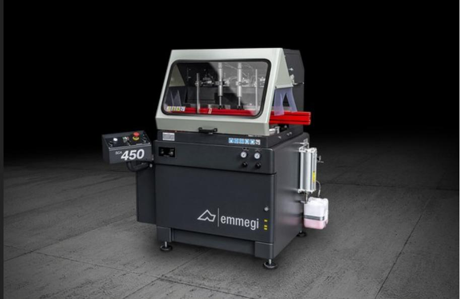
Gehrungssäge mit von unten kommendem Sägeblatt, Zufuhrseite links für 20°-Gehrungen links bis 20°-Gehrungen rechts und Zwischengehren.
