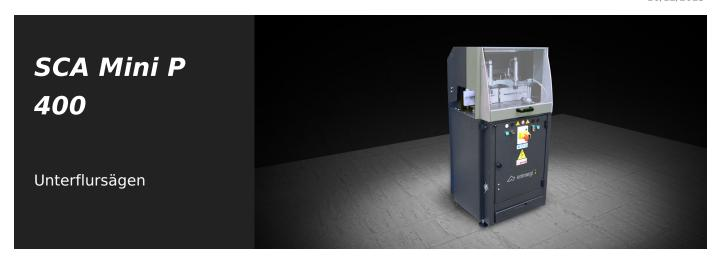
Einkopfsäge mit von unten kommendem, bewegtem Sägeblatt, Zufuhrseite links für 15° Gehrungen links bis 15° Gehrungen rechts und Zwischengehrungen.
