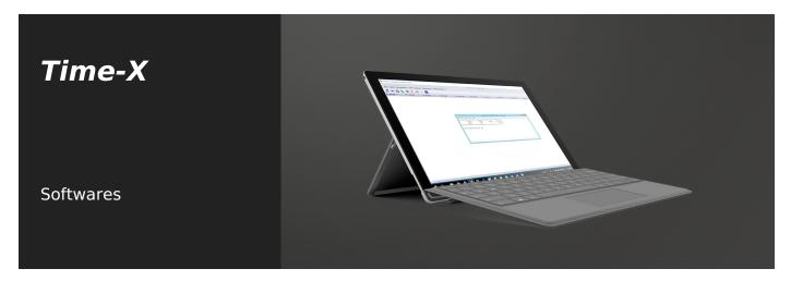
Software für die Simulation von Arbeitszeiten. Bei Maschinen, die mit vorgeschnittenen Stücken arbeiten, berechnet Time-X die Bearbeitungszeit aller Stücke eines Arbeitsbereiches. Bei Maschinen, die mit Profilstangen arbeiten, berechnet Time-X die Bearbeitungszeit jeder Stange. So können bei der Simulation bereits folgende Parameter berücksichtigt werden:
