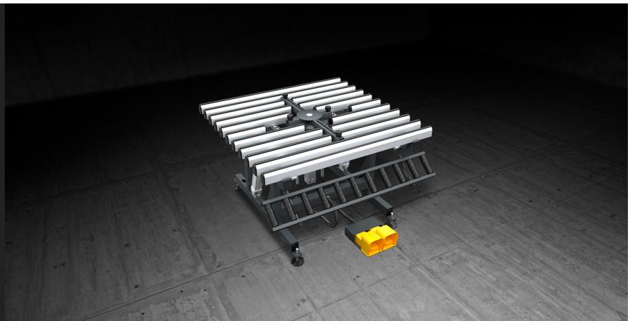
Banco para el ensamblaje de hojas acristaladas con plano de apoyo inclinable desde 0° (horizontal) a 85°. La base de rodillos retráctil puede regularse en altura (desde 170 a 460 mm) independientemente del plano apoyo. El plano de apoyo puede regularse desde 895 a 965 mm y las patas poseen agujeros para su fijación al suelo. Se suministra con una cruceta central para la elevación y el posicionamiento del cristal.
