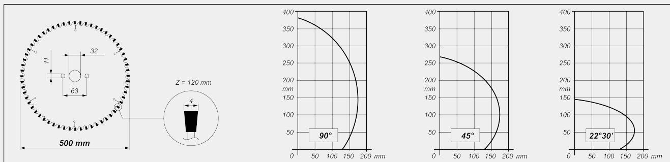
**INCLINACIÓN CABEZAL DE CORTE**
