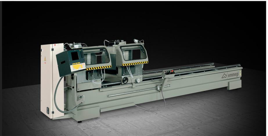
Tronzadora de doble cabezal de 5 ejes para cortes compuestos. Rotación motorizada y controlada electrónicamente del eje horizontal (22°30' externos y 45° internos) y del eje vertical (45° internos). Disco de 500 mm. Disponible con corte útil de 4 y 6 m de longitud.
