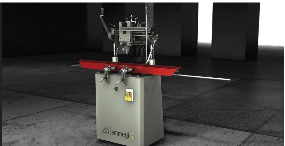
Fresadora copiadora de una unidad de fresado con bajada manual, amplia carrera en altura y traslación de la unidad por medio de empuñadura o palanca indirecta. Posibilidad de realizar mecanizados pasantes sin girar la pieza. Palpador manual.
