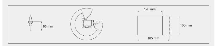
Sección máxima mecanizable en 4 caras - L x H (mm)120 x 100Sección máxima mecanizable (parcialmente) en la cara superior - L x H (mm)185 x 100Amplitud Y mecanizable en cara superior (mm)120
