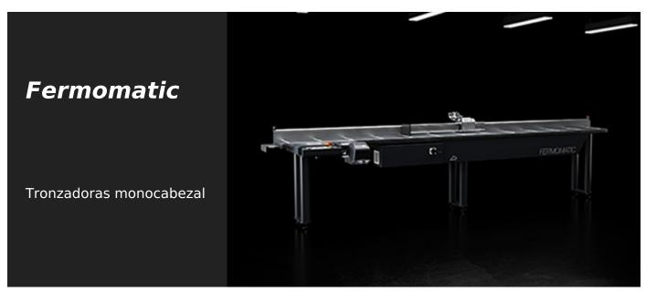
Sistema de revisión de la medición y soporte perfil con movimiento del tope mediante motor brushless y lectura electrónica mediante banda magnética absoluta. Disponible en tres longitudes con alta precisión y repetitividad de posicionamiento.
