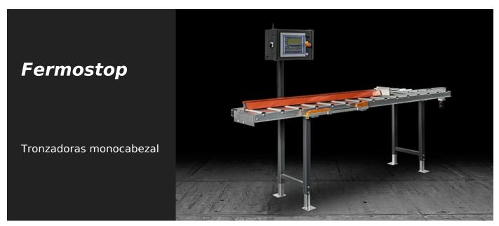
Sistema de revisión de la medición y soporte perfil con movimiento de tope en eje CN y lectura electrónica mediante banda magnética absoluta. Equipado con sistema electrónico de medición que permite guardar los datos en la memoria interna o bien transferirlos en tiempo real a un ordenador o a la unidad de control de una tronzadora por Bluetooth. Permite elaboraciones con alta precisión y repetitividad de posicionamiento.
