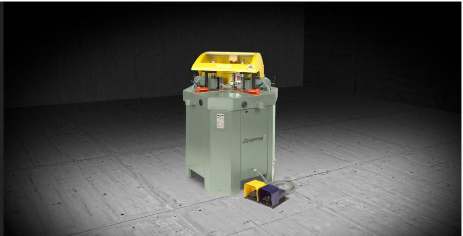
Ensambladora para cerrar ángulos de perfiles de aluminio para puertas, ventanas y fachadas. Se regula fácilmente gracias a la traslación de las unidades de punzonado. Los bloqueos de los cuchillos están dotados de desenganche rápido e imanes para evitar que caigan. Dotada de lectura digital del movimiento de los cabezales de ensamblaje y de la hoquilla de referencia de los perfiles. Las regulaciones son más fáciles gracias a la facilidad de lectura de la pantalla.
