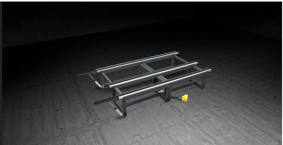
Banco modular de gran tamaño, extensible, para el ensamblaje de carpinterías y modulos de fachadas. Posee 3 planos de apoyo diferentes: uno de PVC blando para el ensamblaje, uno de PVC rígido antifricción para la rotación y una base de rodillos para el desplazamiento en línea.
