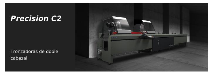
Tronzadora de doble cabezal electrónica con movimiento automático del cabezal móvil mediante motor brushless accionado por un control numérico. Inclinación neumática de las unidades de corte de 90º hasta 22º 30º (externa) con sistema mecánico de regulación de los ángulos intermedios. Avance disco aceite-neumático.
