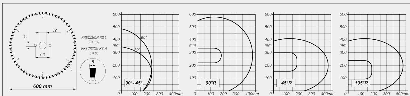
**INCLINACIÓN CABEZAL DE CORTE**
