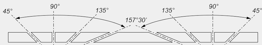
Regulación electrónica de los ángulos intermedios
