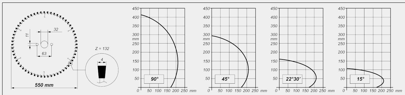
**INCLINACIÓN CABEZAL DE CORTE**
