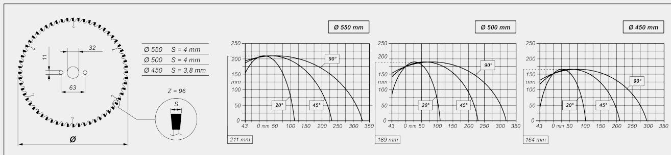
**INCLINACIÓN CABEZAL DE CORTE**
