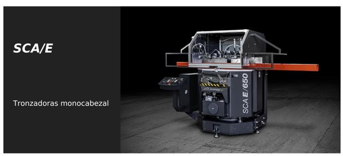
Tronzadora con una unidad de corte ascendente con rotación automática de CN del eje vertical por medio de un motor brushless e inversión simultánea del eje horizontal accionada hidráulicamente. Permite efectuar cortes en angulaciones de 90° a 22°30′ (a la izquierda y a la derecha) en el eje vertical y de 90° a 35° (sólo a la derecha) en el eje horizontal.
