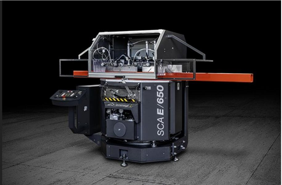
Tronzadora con una unidad de corte ascendente con rotación automática de CN del eje vertical por medio de un motor brushless e inversión simultánea del eje horizontal accionada hidráulicamente. Permite efectuar cortes en angulaciones de 90° a 22°30' (a la izquierda y a la derecha) en el eje vertical y de 90° a 35° (sólo a la derecha) en el eje horizontal.
