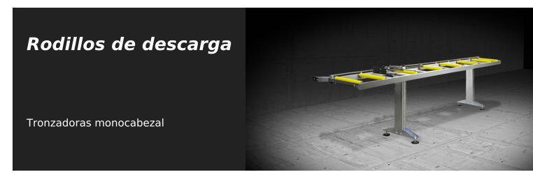
Construcción de acero tubular con patas de montaje ajustables y rollos de acero cubiertos de PVC. En la versión con rollo de 240 mm, la longitud del transportador de rodillos es de 3.500 mm; con rollos de 440 mm, la longitud del transportador de rodillos es de 4.000 mm.
