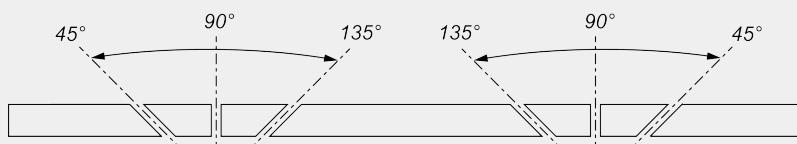
Regulación electrónica de los ángulos intermedios
