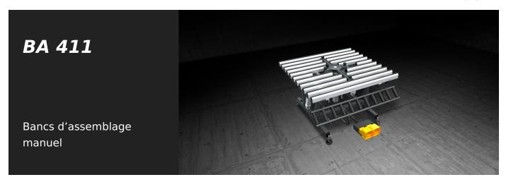
Presse conçue pour l'assemblage de la vitre sur ouvrant munie d'une table de travail inclinable de 0° (horizontal) à 85°. Le chemin d'amenage escamotable est réglable en hauteur (de 170 à 460 mm), indépendamment de la table de travail. Cette dernière est réglable de 895 à 965 mm et ses pieds sont pourvus de perçages pour l'ancrage au sol. Présence d'une croix de soulèvement centrale qui hisse et positionne la vitre.
