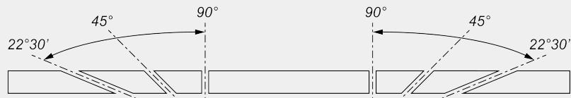
Réglage mécanique des angles intermédiaires
