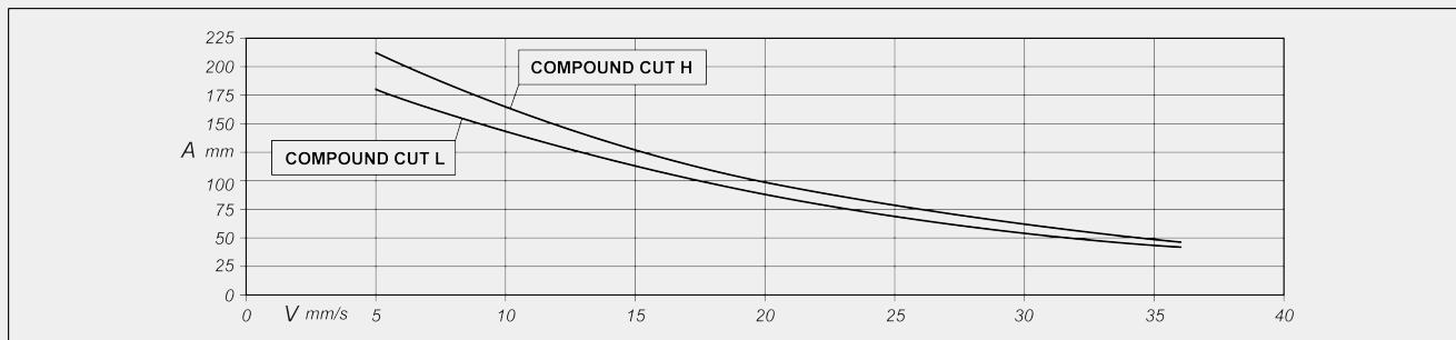
A = arc de contact (mm) V = vitesse d'avance de la lame (mm/s)
