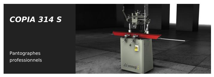
Copia 314 S est une fraiseuse à copier à commande manuelle simple tête disposant d'une large course en hauteur et d'un mouvement de translation de la tête au moyen d'une poignée ou d'un levier indirect. Possibilité de réaliser des perçages débouchants sans tourner la pièce. Palpeur à commande manuelle.
