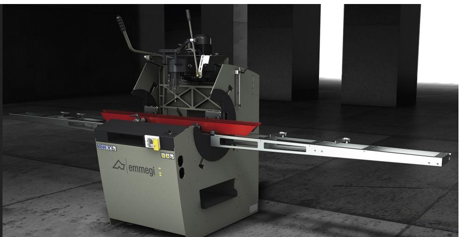
Pantographe à tête simple à commande manuelle avec blocage pneumatique et mouvement de translation de la tête à travers un levier indirect. Possibilité d'effectuer des usinages passants sur aluminium sans tourner la pièce. Plan de travail anti-rayure. Palpeur à commande manuelle.
