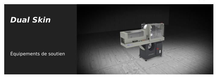
Machine conçue pour l'application d'un film protecteur sur les profilés en aluminium. Des rouleaux motorisés garantissent l'avance automatique du profilé alors que des rouleaux presseurs assurent la parfaite adhésion du film sur le profilé. Un kit supplémentaire en option permet d'appliquer simultanément le film sur une troisième face.
