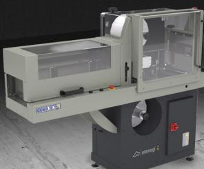
Machine conçue pour l'application d'un film protecteur sur les profilés en aluminium. Des rouleaux motorisés garantissent l'avance automatique du profilé alors que des rouleaux presseurs assurent la parfaite adhésion du film sur le profilé. Un kit supplémentaire en option permet d'appliquer simultanément le film sur une troisième face.
