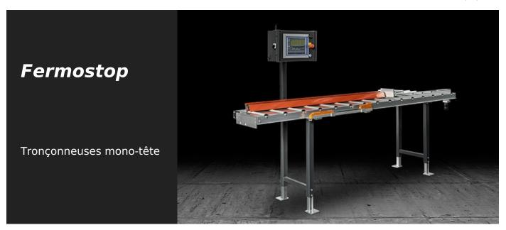
Système de référence mesure et support profil avec mouvement de la butée sur axe à CN et lecture électronique par bande magnétique absolue. Équipé d'un système de mesure électronique qui permet de sauvegarder les données sur une mémoire interne ou de les transférer en temps réel à un PC ou à l'unité de contrôle d'une tronçonneuse via Bluetooth. Permet des usinages avec une grande précision et répétabilité de positionnement.
