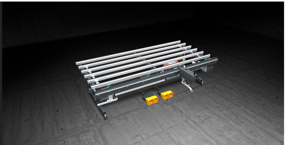
Table pour le montage de ferrures d'oscillo-battant sur ouvrants en aluminium, bois et PVC. Un système d'étaux escamotable assure le serrage de l'ouvrant. La table est équipée d'un système de vissage à alimentation automatique et, en option, d'un système pour le mesurage et la coupe des ferrures au moyen de la cisaille hydropneumatique.
