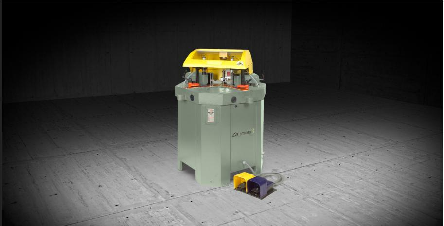
Sertisseuse pour fermer les angles des profilés en aluminium pour portes, fenêtres et façades. Facile à régler grâce à la translation des unités de poinçonnage. Les blocs de couteaux sont équipés de déclenchement rapide et d'aimant pour éviter leur chute. Équipée de lecture numérique du déplacement des têtes de sertissage et de la fourche de référence des profilés. Les réglages sont simplifiés par la facilité de lecture de l'afficheur.
