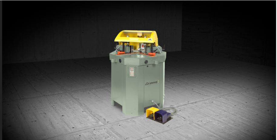
Sertisseuse pour fermer les angles des profilés en aluminium pour portes, fenêtres et façades. Facile à régler grâce à la translation des unités de poinçonnage. Les blocs de couteaux sont équipés de déclenchement rapide et d'aimant pour éviter leur chute. Équipée de lecture numérique du déplacement des têtes de sertissage et de la fourche de référence des profilés. Les réglages sont simplifiés par la facilité de lecture de l'afficheur.
