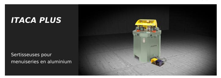
Sertisseuse pour fermer les angles des profilés en aluminium pour portes, fenêtres et façades. Facile à régler grâce à la translation des unités de poinçonnage. Les blocs de couteaux sont équipés de déclenchement rapide et d'aimant pour éviter leur chute. Équipée de lecture numérique du déplacement des têtes de sertissage et de la fourche de référence des profilés. Les réglages sont simplifiés par la facilité de lecture de l'afficheur.
