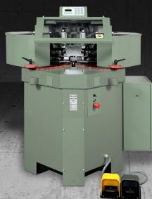
La machine dispose de deux têtes d'usinage spéciales équipées de masses dans lesquelles les 2 couteaux sont réglables dans toutes les positions de sertissage. Les couteaux se déplacent et sont réglables sur l'axe Y (le long du profilé), sur l'axe Z (haut-bas) et sur l'axe X (dans le sens du sertissage). Ces conditions permettent d'éviter le remplacement des outils sur la machine indépendamment des différents types de profilés. Cela réduit les temps et les coûts de mise en place.
