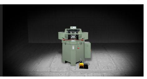
La machine dispose de deux têtes d'usinage spéciales équipées de masses dans lesquelles les 2 couteaux sont réglables dans toutes les positions de sertissage. Les couteaux se déplacent et sont réglables sur l'axe Y (le long du profilé), sur l'axe Z (haut-bas) et sur l'axe X (dans le sens du sertissage). Ces conditions permettent d'éviter le remplacement des outils sur la machine indépendamment des différents types de profilés. Cela réduit les temps et les coûts de mise en place.
