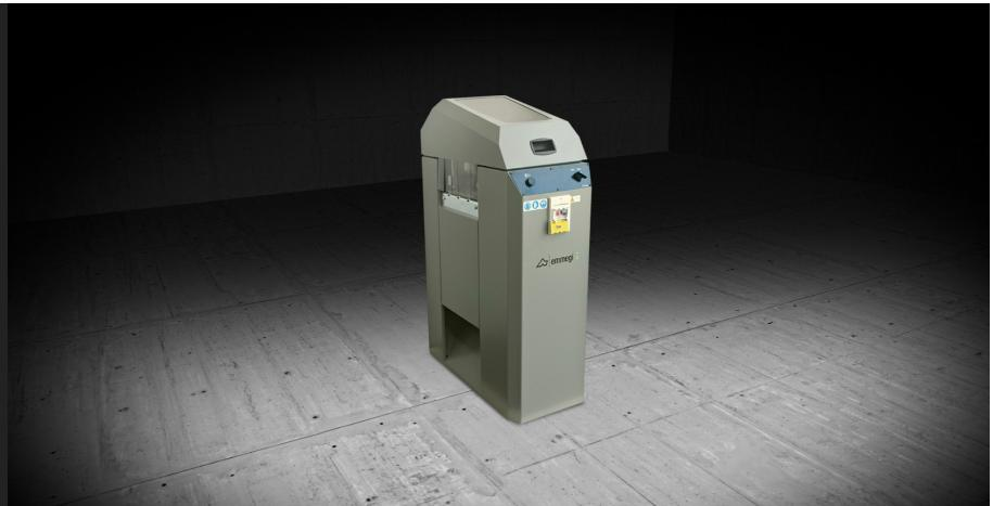
Grueuse en bout horizontale à avance manuelle. Fraisage droit de 90°. Changement rapide du groupe de fraisage assuré par commande à levier. Table de travail anti-rayures. Protection intégrale de la zone d'usinage.
