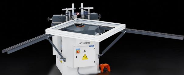
Sertisseuse pneumatique pour le pressage de profilés de grandes dimensions et de façades structurées, avec des exigences de qualité élevées. Ses principaux atouts sont les suivants : la facilité de configuration et d'utilisation, avec des temps d'outillage et de réglage minimes ; l'extrême robustesse de la structure, qui permet une grande précision d'usinage ; la force de pressage élevée est fournie par un vérin à soufflet de grand volume et sans entretien.
