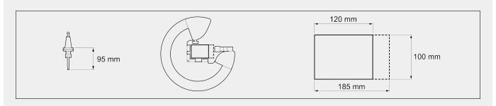
Section maximum usinable sur 4 faces - L x H (mm)120 x 100Section maximum usinable (partiellement) sur la face supérieure - L x H (mm)185 x 100Largeur Y usinable sur la face supérieure (mm)120
