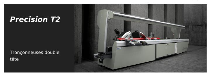
Coupeuse à double tête à 3 axes contrôlés pour l'aluminium, le PVC et les alliages légers, avec un mouvement automatique de la tête mobile et une gestion électronique de tous les angles de 45° (internes) à 15° (externes) avec une précision, à l'intérieur de chaque degré, de 280 positions. Dans la version de base, l'avancement de la lame est actionné par deux vérins oléopneumatiques. Lame de 550 mm. Disponible avec une coupe utile de 5 m ou 6 m de long.
