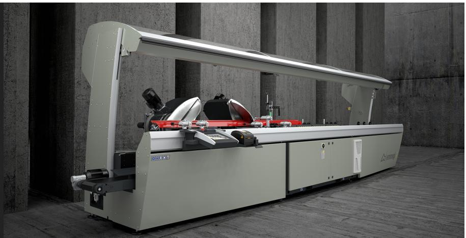
Coupeuse à double tête à 3 axes contrôlés pour l'aluminium, le PVC et les alliages légers, avec un mouvement automatique de la tête mobile et une gestion électronique de tous les angles de 45° (internes) à 15° (externes) avec une précision, à l'intérieur de chaque degré, de 280 positions. Dans la version de base, l'avancement de la lame est actionné par deux vérins oléopneumatiques. Lame de 550 mm. Disponible avec une coupe utile de 5 m ou 6 m de long.
